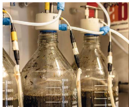
Dettaglio dei reattori di processo del dispositivo per la misurazione del potenziale metanigeno presente presso Crpa Lab
