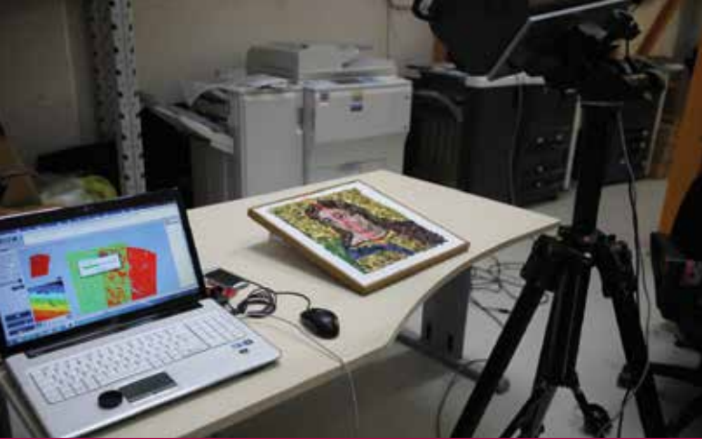
Fig. 5 - Scansione 3D: acquisizione mediante laser scanner ad alta risoluzione della superficie del mosaico (a cura di GEIS Srl).
