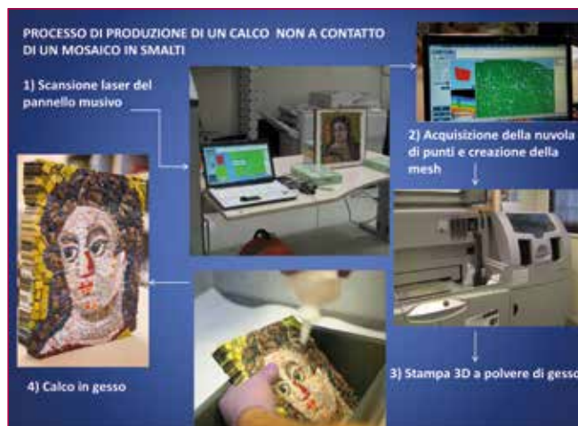
Fig.8 -Visualizzazione mediante immagini del processo di produzione del calco non a contatto di un mosaico a smalti.
