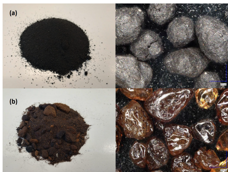
Fig. 1: Sabbie verdi legate con argilla bentonitica (a) e sabbie legate con resine fenoliche termoindurenti (b)
