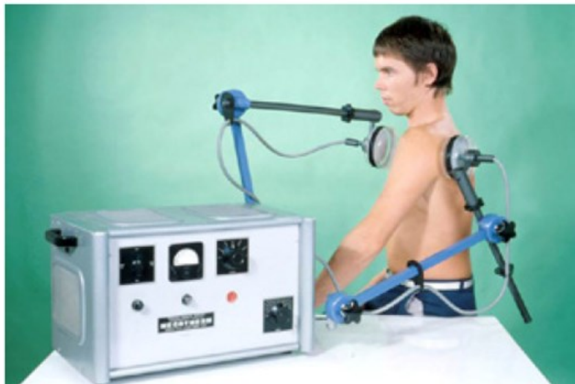
Figura 3: Esempio di apparecchiatura per diatermia a onde corte (Da: Guida non vincolante di buone prassi per l'attuazione della Direttiva 2013/35/UE relativa ai campi elettromagnetici. Volume 2: Studi di casi. Commissione europea. Direzione generale per l'Occupazione, gli affari sociali e l'inclusione. Unità B.3. Lussemburgo: Ufficio delle pubblicazioni dell'Unione Europea, 2015)
