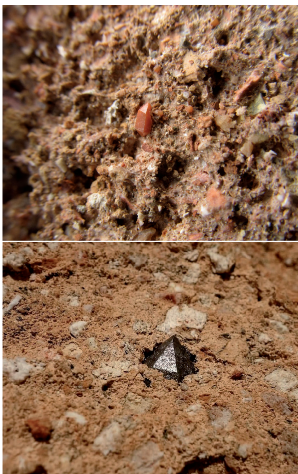
Fig. 6. Intonaci rosa a Sologno (Reggio Emilia, a sinistra) e Albarracín (Spagna a destra) contenenti cristalli bipiramidati di quarzo nero (Sologno, un centimetro di lunghezza) e rosso (Albarracín, tre millimetri di lunghezza). Sono visibili frammenti bianchi di gesso poco cotto e altri minuti grumi di ossidi e idrossidi di ferro responsabili della colorazione degli intonaci.
