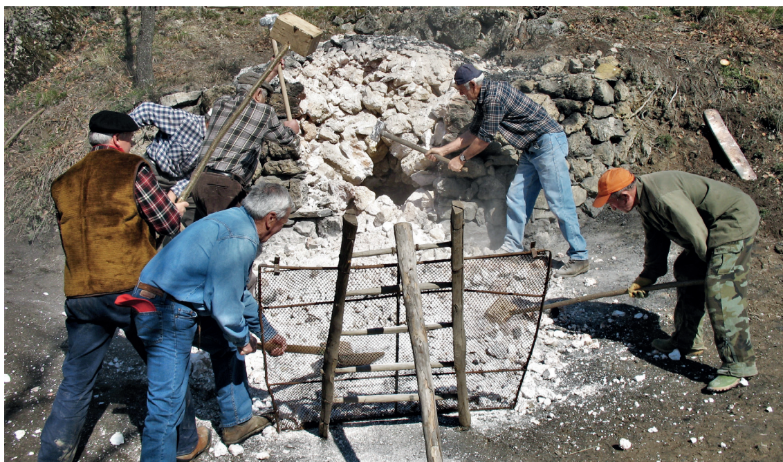
Fig. 5. Sologno (Reggio Emilia). Apertura di una fornace da gesso dopo la cottura. Le zolle di roccia cotta vengono percossi con mazzuoli di legno e poi setacciate per ottenere la scagliola.
