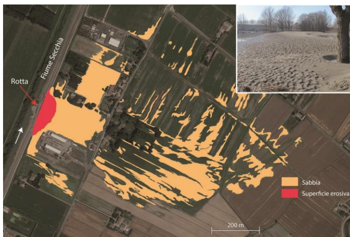
Fig. 2. Le sabbie abbandonate dalla rotta del fiume Secchia nel 2014 hanno formato in soli tre giorni un corpo sedimentario a forma di ventaglio (ventaglio di rotta). All'apice del ventaglio si è depositato uno spessore di circa un metro di sabbia mentre ai margini sono stati depositi solo pochi centimetri. Nelle altre zone allagate a nord del ventaglio si è depositato uno spessore di pochi millimetri di fango. Nell'inserito in alto sono visibili le increspature da corrente nelle sabbie a circa 200 m dalla breccia. La forma delle increspature indica la direzione della corrente in uscita dalla breccia nell'argine, che nell'immagine va da sinistra verso destra (mappa del ventaglio di rotta da BIGI, LUGLI, FONTANA 2015)
