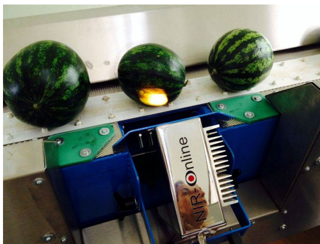
Figura 1. Modalità di acquisizione degli spettri per ciascun frutto mentre passa sul nastro trasportatore della linea calibratrice.
