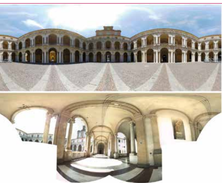
Fig. 5 - In alto l'immagine panoramica del cortile d'onore ottenuta da fotocamera reflex ( Canon EOS 5D Mark II ); in basso immagine semisferica interna al porticato superiore ottenuta dalle fotocamere del Pegasus Backpack .
