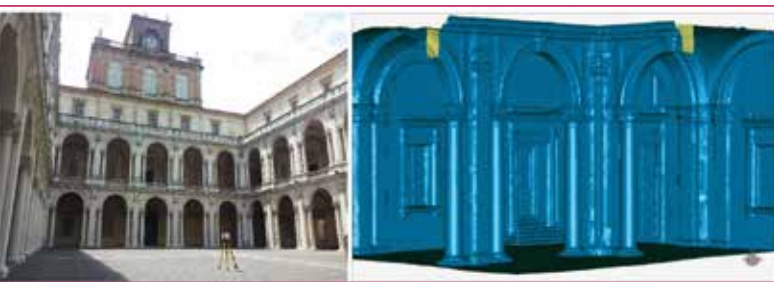
Fig. 4 - Le operazioni di rilevamento con laser scanner terrestre (ScanStation C10, Leica Geosystems) a sinistra e dettaglio relativo ad una porzione del colonnato che delimita il Cortile d'Onore, a destra, ottenuta dopo meshing della nuvola di punti.
