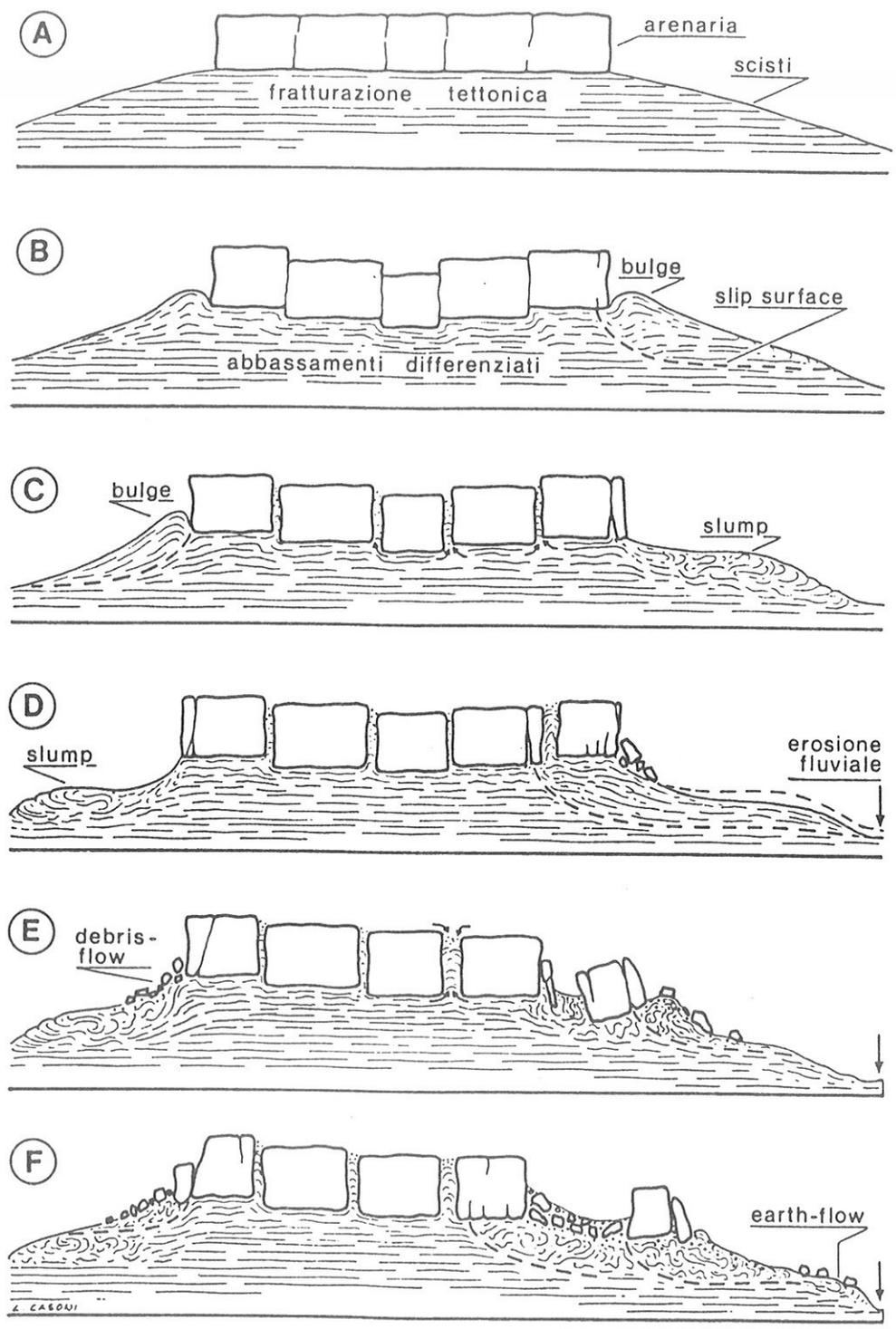
Fig. 7 - Schema del modello evolutivo del meccanismo di rottura di una placca "rigida" sovrastante a formazioni argilloscistose a comportamento duttile.
