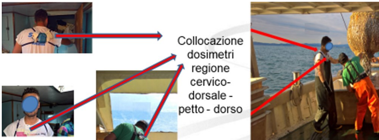
Figura 2. Campagna di misura dell'esposizione individuale a radiazione UV solare effettuata con dosimetri elettronici nel settore della pesca
