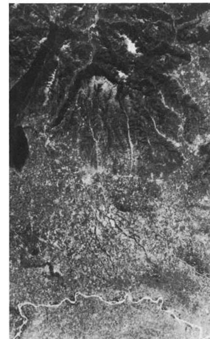
Foto 3.1 — Fotografia del Large Format Camera (scala 1:770.000 circa) della missione spaziale Shuttle 41 (Ottobre 1984). Tra il margine alpino ed il F. Po si individua l'ampia zona di tono più chiaro, a forma di ventaglio, corrispondente al «grande conoide terrazzato» del F. Adige.
