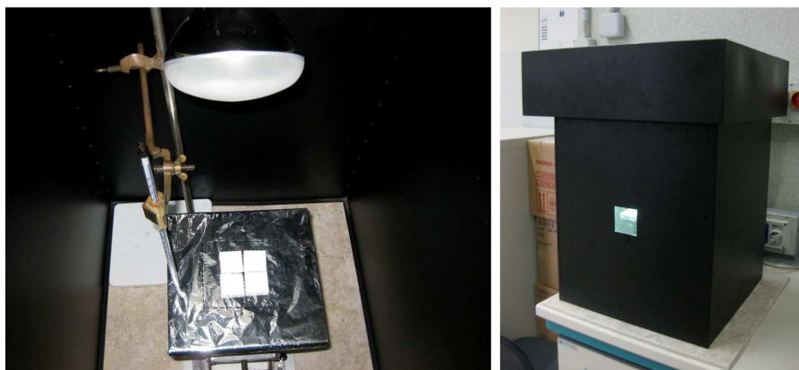
Figura 71 Interno ed esterno della camera per le prove di invecchiamento
