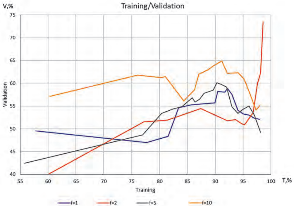
Рис. 2. Зависимость точности измерения тестовой базы (V, %) от точности дискриминации обучающей базы (T, %) для различной частоты дискретизации БПВ с учетом количества накоплений межкадровой разности при обучении ИНС
