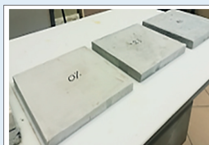
Fig.3: Campioni compositi per la misurazione della conduttività termica
