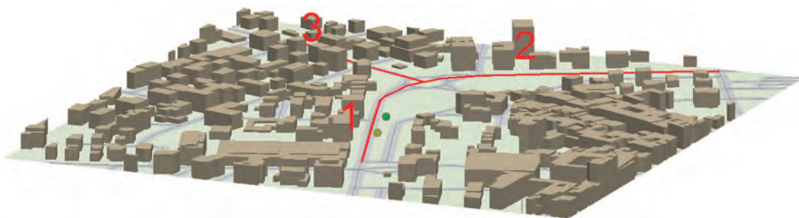
Figura 3 – Volumetria degli edifici e geometria stradale nella simulazione MSS del dominio, ove: stazione ARPAE (punto verde), radar conta-traffico (punto giallo) e tratti stradali 1, 2 e 3, considerati come sorgenti lineari di emissione (linee rosse)
