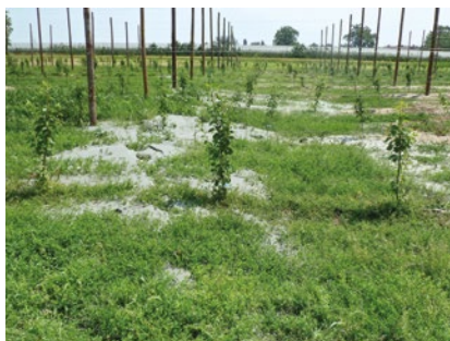
Figura 6. A sinistra, vulcanetto di sabbia verificatosi in seguito ad un carotaggio nel maggio 2014 presso Bondeno (Ferrara). A destra, numerosi vulcanetti di sabbia indotti dal sisma del 29 maggio 2012 presso San Possidonio (Modena).
