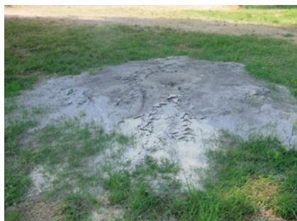
Figura 6. A sinistra, vulcanetto di sabbia verificatosi in seguito ad un carotaggio nel maggio 2014 presso Bondeno (Ferrara). A destra, numerosi vulcanetti di sabbia indotti dal sisma del 29 maggio 2012 presso San Possidonio (Modena).
