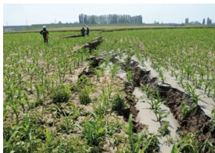
Figura 4. A sinistra, fratture nel terreno con fenomeni di liquefazione presso S. Carlo. (Ferrara) indotte dal sisma del 20 maggio 2012. A destra, vulcanetto di sabbia per fenomeno di liquefazione indotto dal sisma del 29 maggio 2012 presso Moglia di Gonzaga (Mantova).
