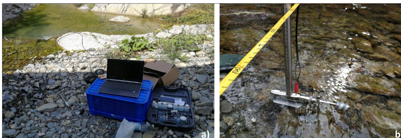
Figura 2 – Tecniche utilizzate per la misura della portata dei torrenti e delle Fonti di Poiano. a) tecnica del tracciante salino Q-pdt; b) tecnica del correntometro Q-cm.
